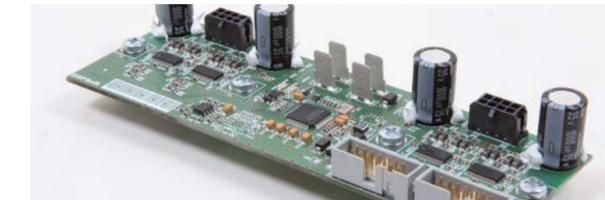
Die Line Arrays sind mit exzellenten THD + N Verstärkereinheiten ausgestattet. Sie sind kurzschluss- und thermisch geschützt. Eine Pop-free Ausführung ist integriert.
